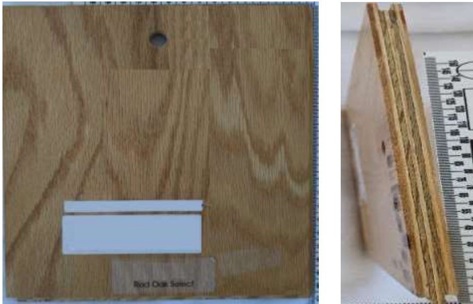
Image 6. Panneaux multicouches assemblés (surface de parquet) décrits à la sous -position 4418.75 - Photo d'un panneau multicouches assemblé avec surface supérieure de multiples lames, et deuxième photo de la coupe transversale du panneau multicouches assemblé.
