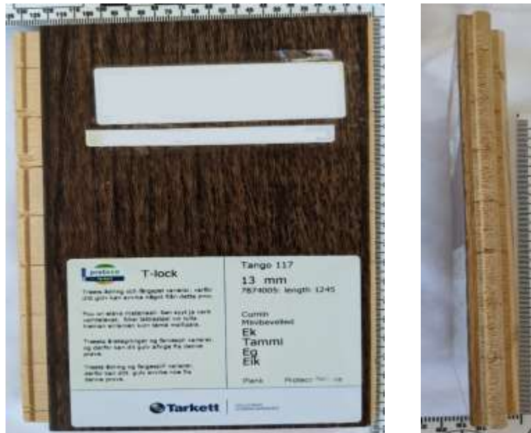
Image 3. Panneaux en bois stratifiés (contre -plaqué panneauauté) décrits à la sous -position 4412.94 - Photo d'un panneau en bois stratifié avec une feuille de stratifié tournée face vers le haut, contre -plaqué panneauauté et dos de la feuille de stratifié, et deuxième photo de la coupe transversale du panneau en bois stratifié.
