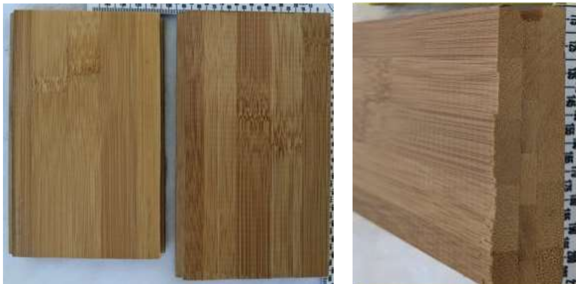
Image 4. Panneaux de bambou multicouches et assemblés, décrits à la sous -position 4418.73 - Photo d'un panneau de bambou multicouches de deux lames ou plus sur la surface supérieure, et deuxième photo de la coupe transversale du panneau multicouches se composant de plusieurs lames assemblées sur chacune des couches du dessus, du milieu et du dessous.
